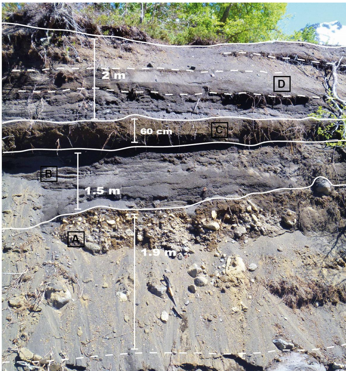
Figura 24. Depósitos del sector proximal en el estero Shangri-La a una distancia de 9 km del cráter. Estos son de base a techo: un depósito de flujo de detritos de 1.9 m de espesor (A), de origen piroclástico retrabajado, sobre este un depósito lahárico de granulometría fina, color gris oscuro, de 1.5 m potencia con estratificación horizontal (B), el cual subyace a un depósito piroclástico de 0.6 m de espesor (C) y finalmente en el techo un depósito de 2 metros de potencia, color gris, correspondiente a varios pulsos laháricos, de granulometría fina, con estratificación horizontal (D).
