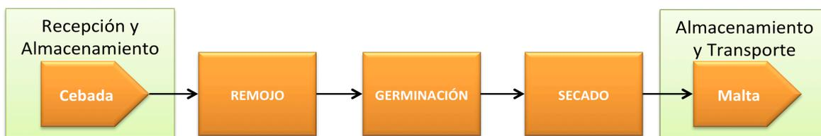
Figura 4 – Diagrama de bloques del proceso de elaboración de malta denominado malteo. La materia prima, cebada, y el producto terminado, malta, se someten a condiciones especiales de guarda mientras que las etapas de transformación corresponden a Remojo, Germinación y Secado.
