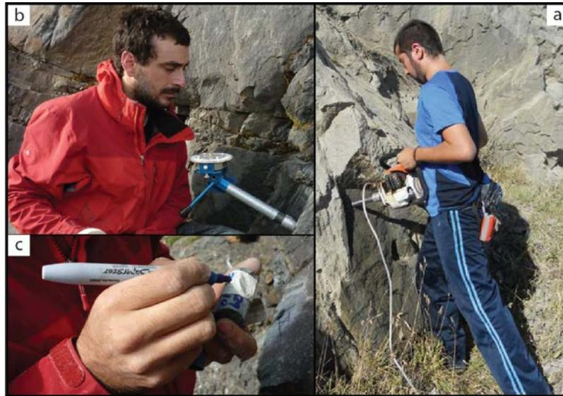
Figura I.4.1. Técnica de muestreo. a) Extracción de testigo con perforadora adaptada b) Orientación mediante compás magnético y de sol. c) Etiquetado de la muestra.
