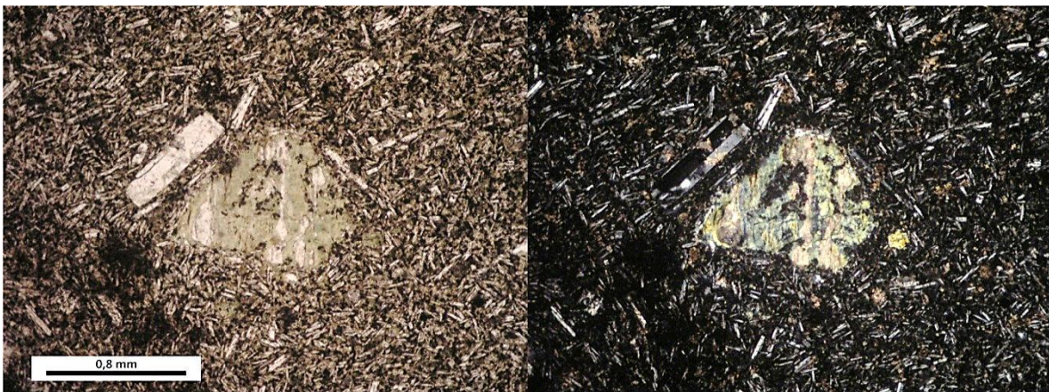
Figura 4.3. Microfotografía a nícoles paralelos y cruzados de una sección transparente de lavas de la unidad Inferior de la Secuencia Puerto Inglés. Fenocristales de plagioclasa y piroxeno indistinguible debido a la intensa alteración a clorita y carbonatos (muestra LL270711-5).
