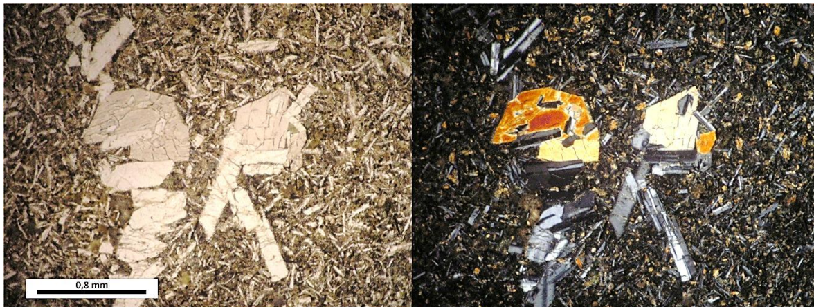
Figura B.03. Microfotografía (PPL y XPL) de sección transparente representativa de la muestra LL230711-6. Se observa textura glomeroporfírica con fenocristales de plagioclasa y clinopiroxeno.
