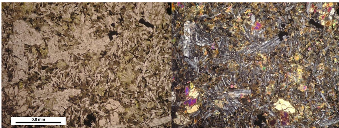
Figura B.04. Microfotografía (PPL y XPL) de sección transparente representativa de la muestra LL230711-7. Destacan fenocristales de plagioclasa y clinopiroxeno en una masa fundamental intergranular alterada a esmectita.
