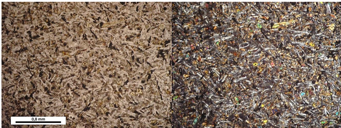
Figura B.23. Microfotografía (PPL y XPL) de sección transparente representativa de la muestra LL250711-8. Masa fundamental intergranular con plagioclasa, titanoaugita, olivino y opacos.
