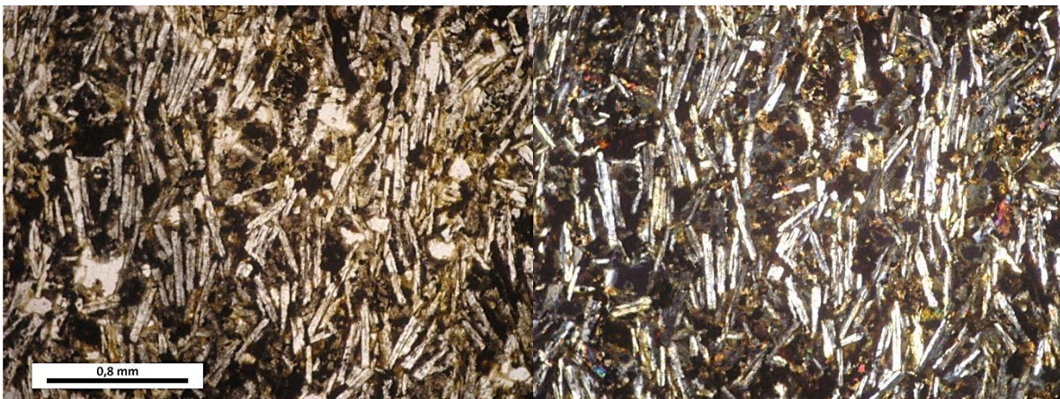
Figura B.15. Microfotografía (PPL y XPL) de sección transparente representativa de la muestra LL240711-7. Se observa textura pilotaxítica entre cristales de titanogaugita y plagioclasa.
