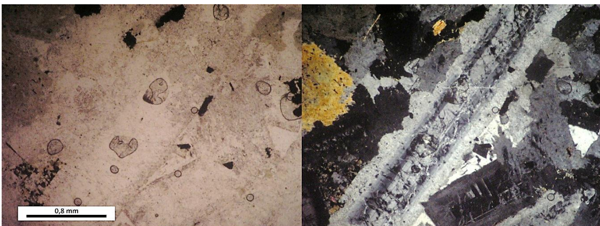
Figura 4.15. Microfotografía a nicoles paralelos y cruzados de una sección transparente característica de la unidad 'Intrusivo de Punta Larga'. Cristal de plagioclasa con bordes de recrecimiento y fracturas rellenas por feldespato potásico (ortoclasa) (muestra LL270711-1).
