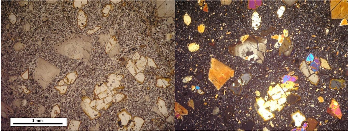
Figura 4.12. Microfotografía a nicoles paralelos y cruzados de una sección transparente típica de la Secuencia Bahía del Padre. Abundantes fenocristales de olivino y titanaugita, así como intensa zonación de estos últimos (muestra LL230711-2).
