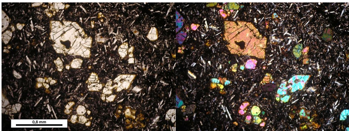
Figura B.21. Microfotografía (PPL y XPL) de sección transparente representativa de la muestra LL250711-6. Se observan gran cantidad de fenocristales subhedrales de olivino.
