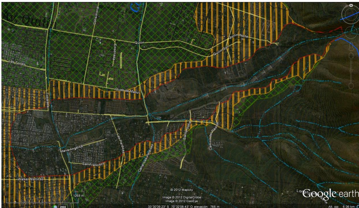
**ILUSTRACIÓN 37:** DETALLE DE ÁREA DE PELIGRO ALTO, DENTRO DE LA LÍNEA ROJA, SOBRE IMAGEN GOOGLE EARTH
