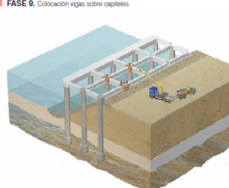
FASE 9. Colocación vigas sobre capiteles
