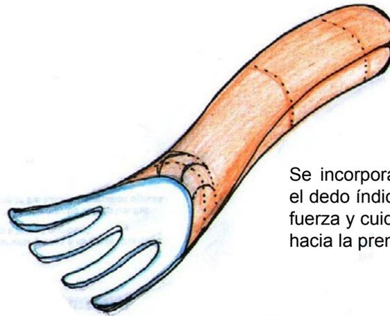
Se incorpora una superficie de apoyo para el dedo índice, para dirigir la aplicación de la fuerza y cuidar de que la mano no se deslice hacia la prensa
