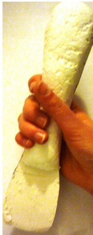
Al probar las maquetas se observa que la dimensión de la herramienta permite el agarre correcto, pero se requiere de disminuir aun más la intensidad de la curva.
