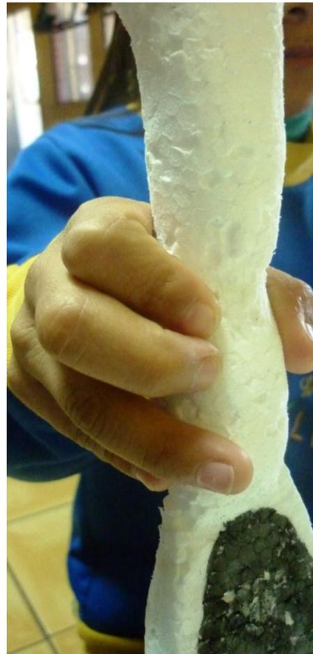
La maqueta tiene como finalidad generar una superficie lineal de agarre, donde el centro se proyecta curvas para la contraforma de la mano. El diámetro del mango permite el agarre pero es necesario disminuir la intención de las curvas. El largo esta sobredimensionado intensionalmente, para observar las relaciones de tamaño y las distancias que se generan.
