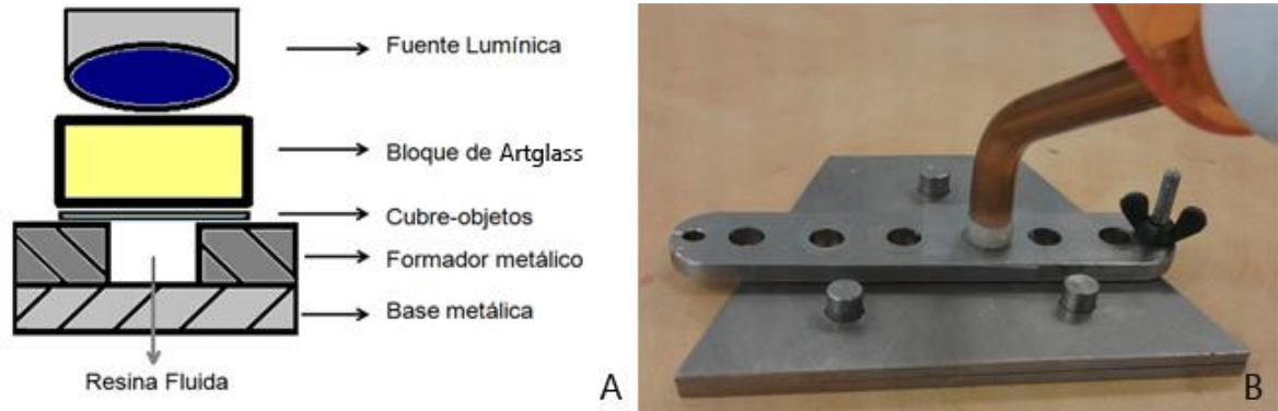
Figura 5: Esquema del proceso de foto-polimerización modificado de Aranda y Cols. (66) (A) Resina Wave en el formador metálico de 4mm de profundidad, donde se puede apreciar el cobre-objeto interpuesto así como el bloque de Art-Glass de 4mm interpuesto previo a su polimerización (B).
