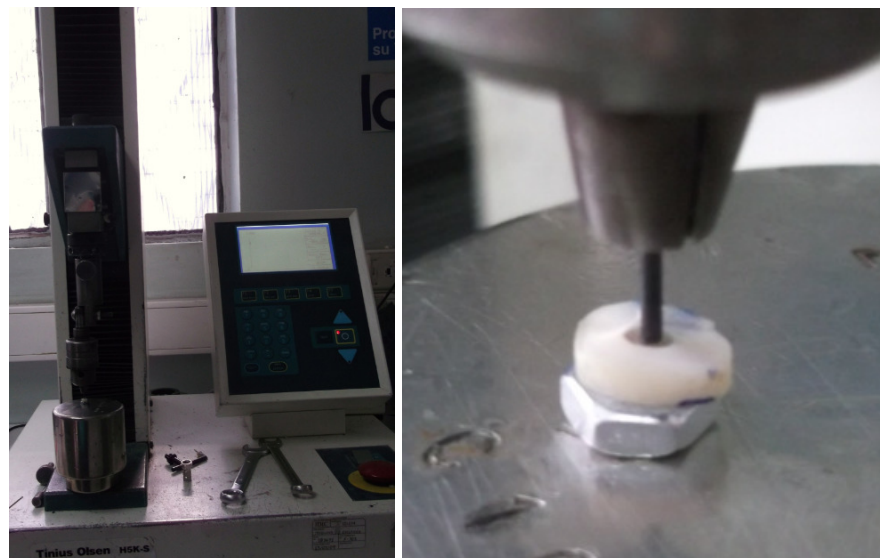
Fig. 13. Máquina de ensayos universal Tinius Olsen HK5-S y Push-out Test.
