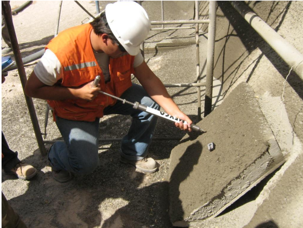
Figura II.3: Fotografía de Medición de Resistencia Temprana con Penetración de Aguja
