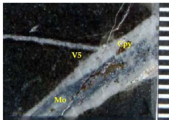
Figura 3.7: Veta de cuarzo V5, sin halo, con calcopirita y molibdenita depositada en sutura central. (Superintendencia de Geología División El Teniente, 2003).
