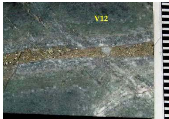
Figura 3.14: Vetilla V12, con calcopirita masiva y cuarzo subordinado. El doble halo es de bordes nítidos y sinuosos (superintendencia de Geología División El Teniente, 2003).
