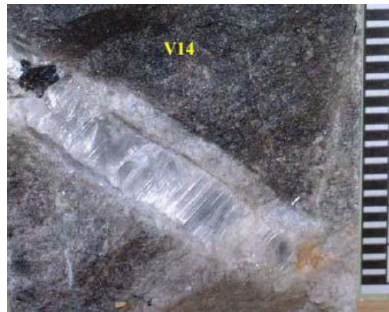
Figura 3.16: Vetilla de yeso masivo con calcita y bornita subordinada. El halo sericítico es de bordes nítidos y poco desarrollado (superintendencia de Geología División El Teniente, 2003).
