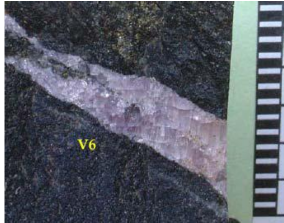
Figura 3.8: Veta de anhidrita V6, sin halo (superintendencia de Geología División El Teniente, 2003).
