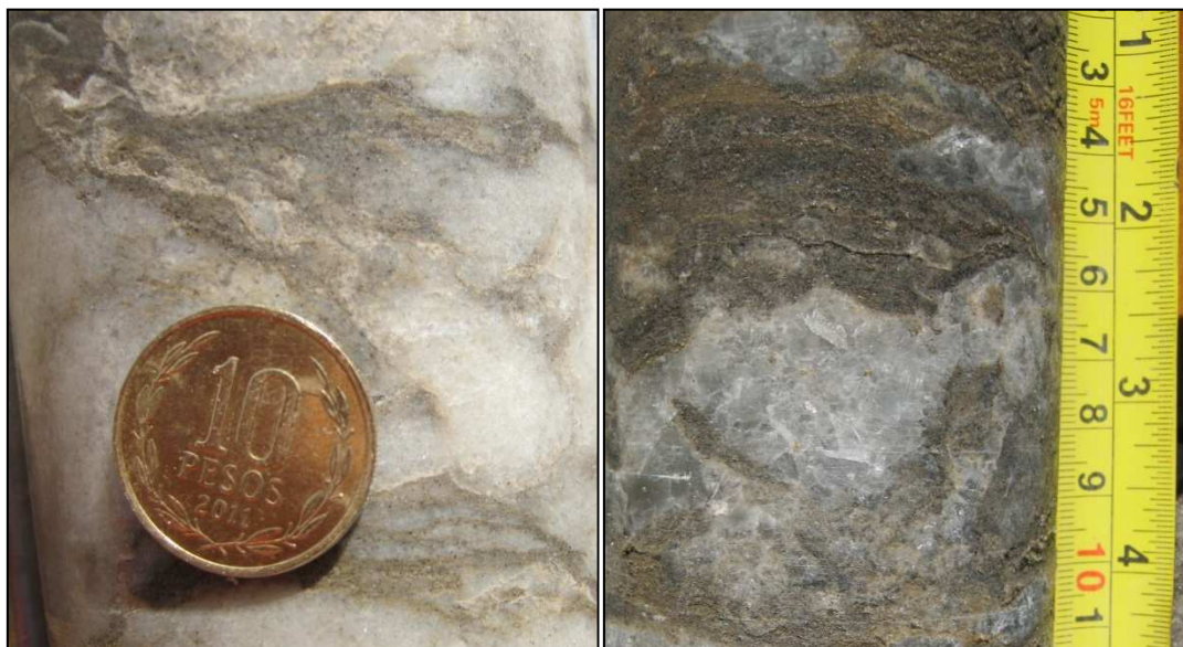
Figura 33: Sulfatos masivos intercalados irregularmente con material clástico. A la izquierda una muestra del pozo DEC-05 a 250 m de profundidad. A la derecha una muestra del pozo DEC-04 a 185 m de profundidad
