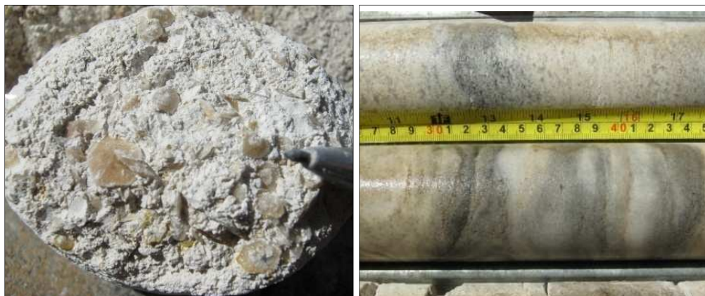
Figura 25: Sucesión sedimentaria evaporítica. A izquierda: Maclas penetrativas simples en cristales de yeso (DEC-04, 180 m de profundidad). A la derecha: Sulfatos masivos con intercalaciones clásticas (DEC-04, 210 m de profundidad).
