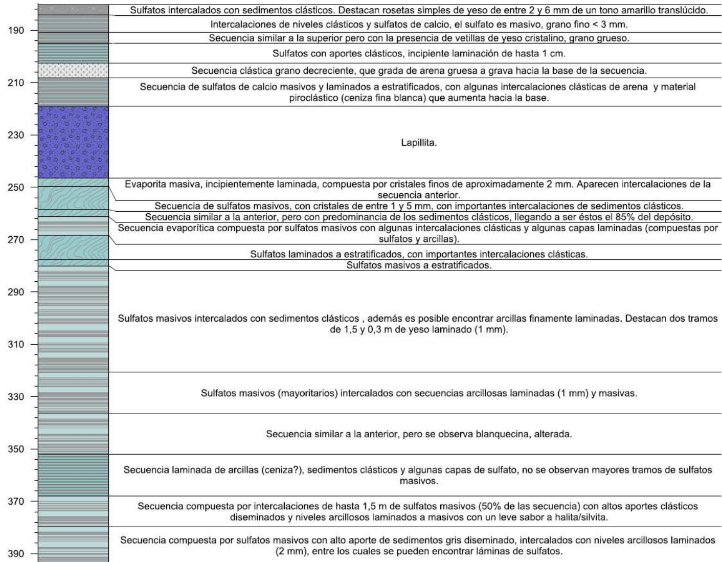
Figura 26: Detalle de la sucesión sedimentaria evaporítica en el pozo DEC-04.
