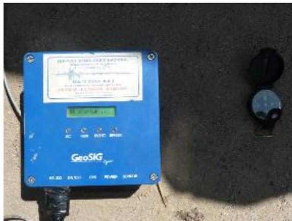
Figura 3.1: Sismómetro utilizado en las mediciones
