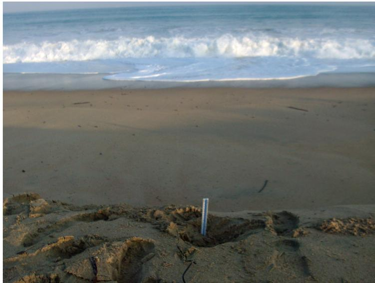
Figura 4.5: “Ejemplo de posicionamiento de arreglo triaxial de sensores”
