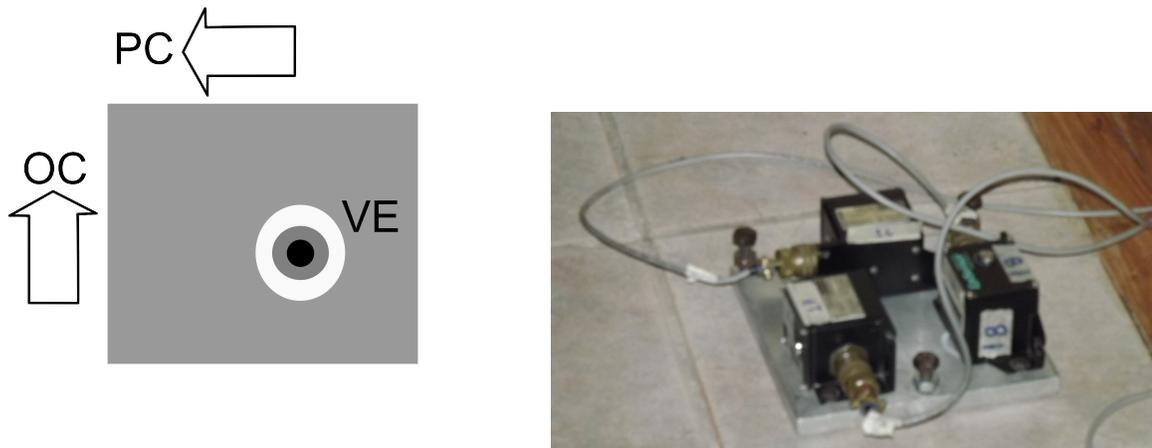
Figura 4.7: “Disposición acelerómetros en planta de edificio. Piso 1”
