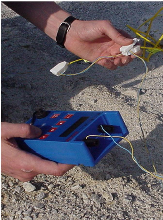
**Figura 11: Conexión y registro de detonadores.**
