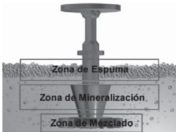
Figura 7. Zonas típicas en una celda de flotación [24].
