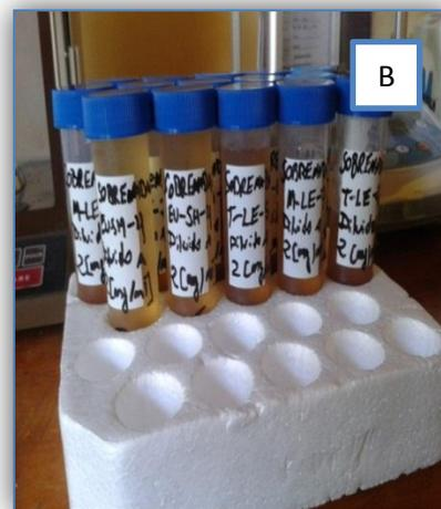
Ilustración 15. Dilución fases líquidas de sacarificaciones. A: Proceso de dilución, se agregó tampón Acetato de Sodio 0,05 M y pH 4,8 con el uso de una bureta B: Fases líquidas de sacarificación diluidas a una concentración de  $2 \frac{g}{L}$  de glucosa. Lugar: Departamento de Ingeniería de la Madera y sus Biomateriales de la Facultad de Ciencias Forestales de la Universidad de Chile.
