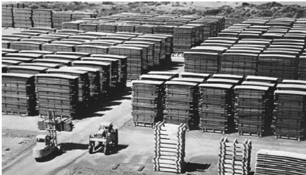
**Figura 21:** Patio de secado natural de tablas empacadas en pilas. Pueden distinguirse claramente los pasillos dispuestos para la circulación del aire.
