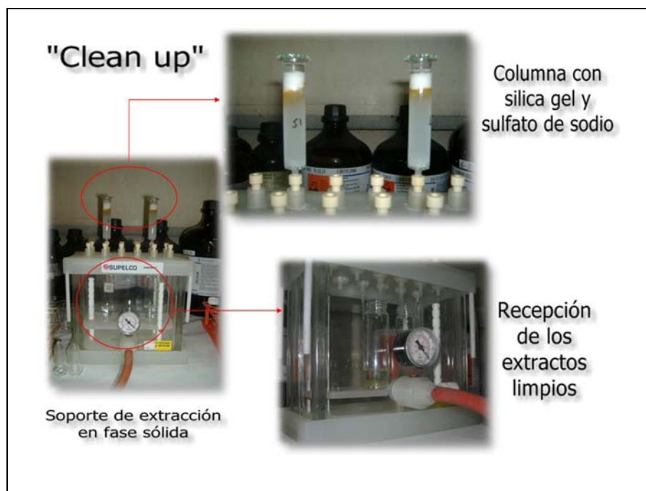
Figura 7: Proceso de limpieza de los extractos o “clean up”
