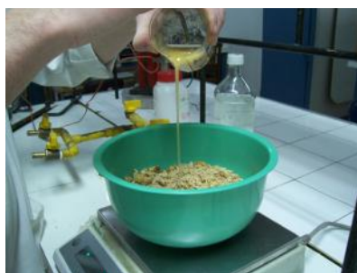
Figura A6.5: Adición de solución aglomerante.
