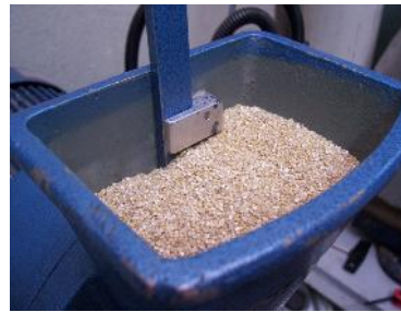
Figura A2.1 y A2.2: Disposición de la quínoa en el molino de martillo – cuchillo para la molienda del grano.
