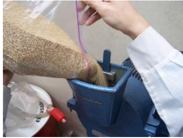
Figura A2.1 y A2.2: Disposición de la quínoa en el molino de martillo – cuchillo para la molienda del grano.
