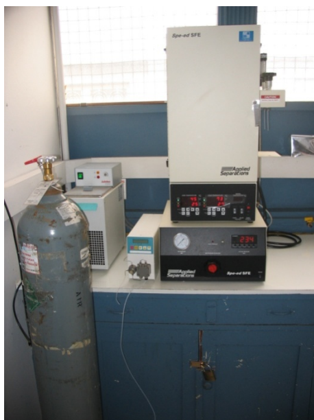
Figura 16. a) Esquema extractor supercrítico Applied Separations, b) Fotografía
