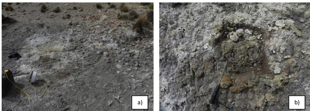
Figura 4.28. Detalle de 1) de la fig. 4.27. a) extensión completa. b) lugar de medición, en este se aprecia la marca que deja la cámara al ser enterrada en el suelo.
