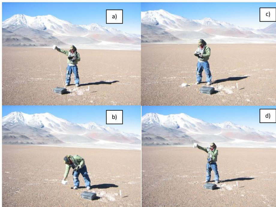
Figura 3.6. Procedimiento de medida de CO<sub>2</sub>-DDS. a) Medición de CO<sub>2</sub> atmosférico. b) y c) Colocar cámara de acumulación en el suelo para medir aumento de concentración de CO<sub>2</sub>-DDS. d) Nuevamente medición de CO<sub>2</sub> atmosférico.
