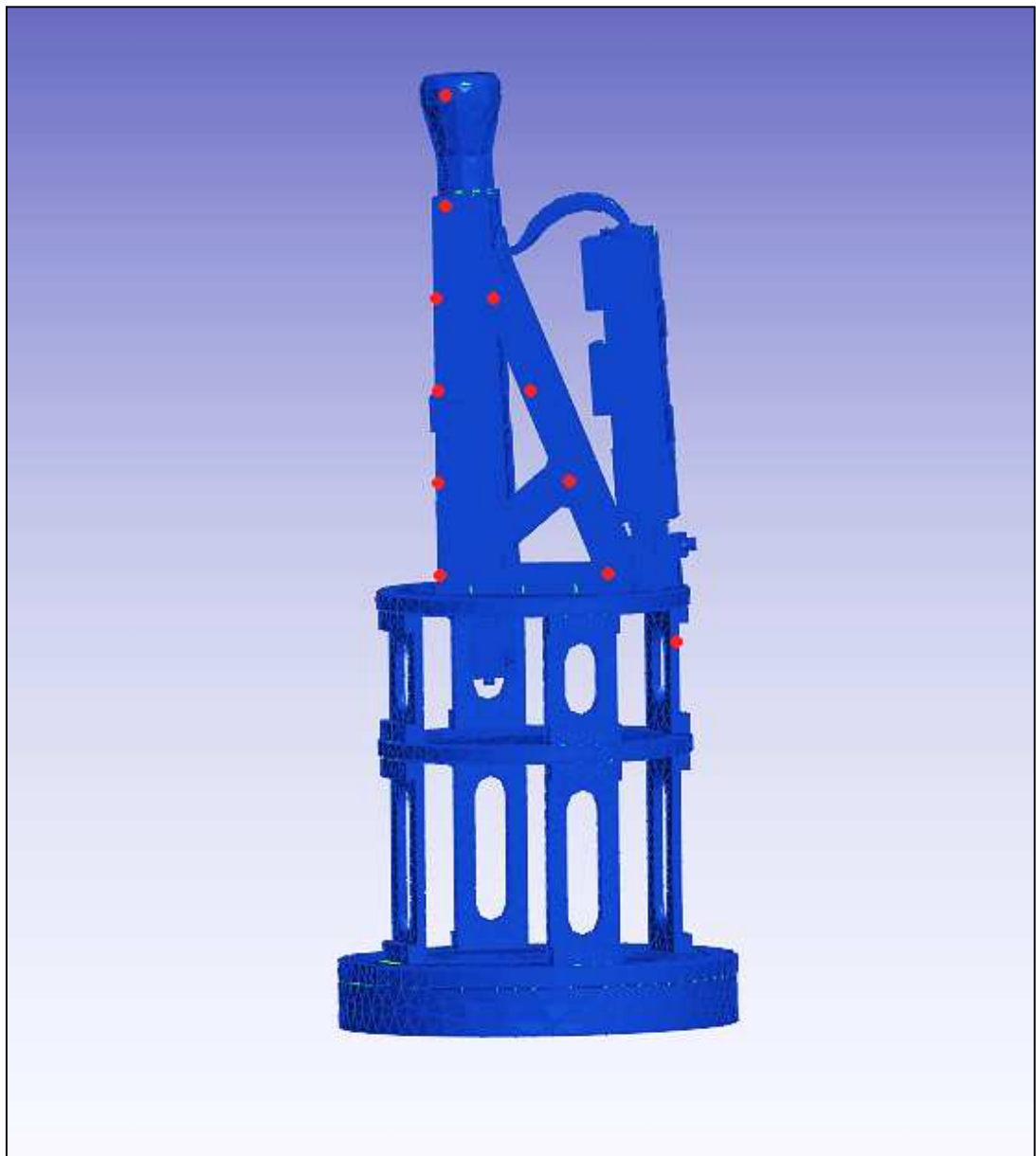
Figura 4-15: 1er Modo de Vibración del Modelo Experimental
