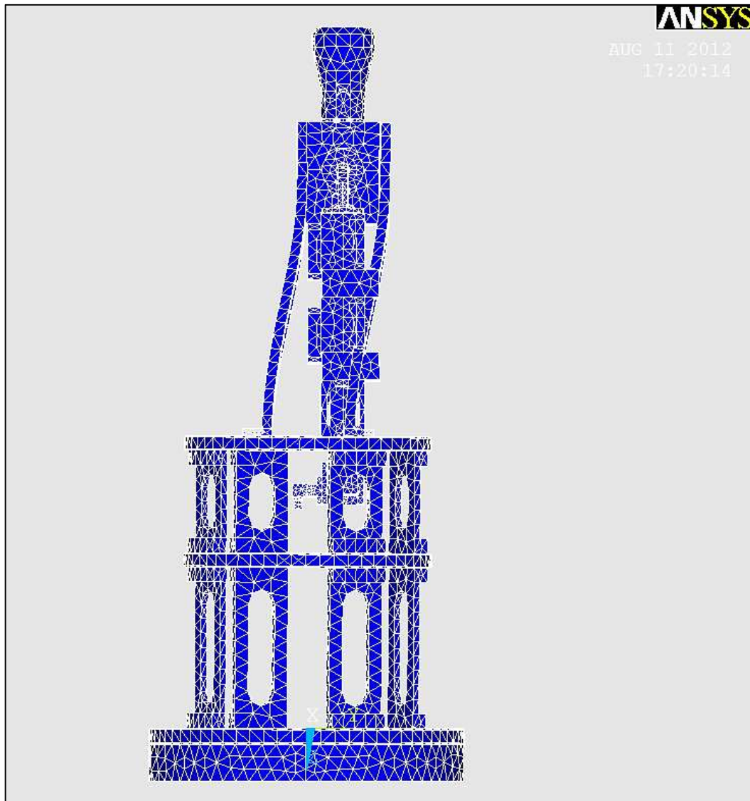
Figura 4-8: Imagen del primer modo de vibración del modelo
