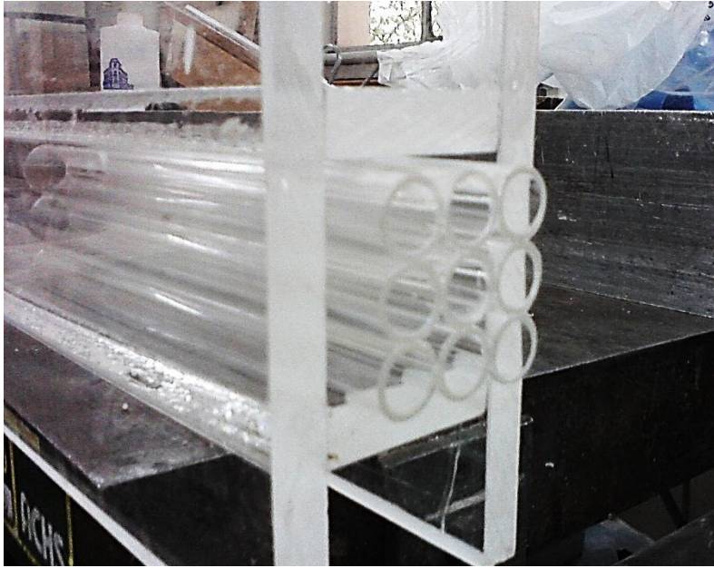
Figura 7: Detalle del panal de abejas o alineador de flujo.
