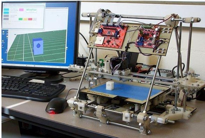
Ilustración 3: Impresora 3D RepRap[7]
