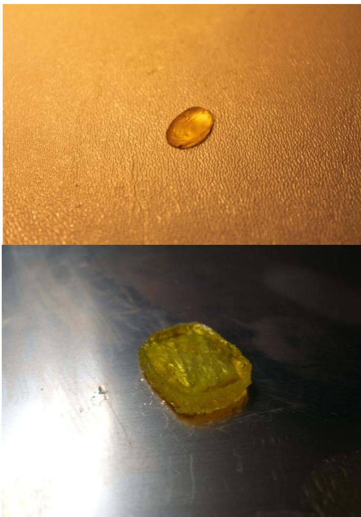
Ilustración 47: Ejemplos de Impresión fallida debida a falta de material, se puede apreciar que la superficie no está plana , debido a que hubo lugares donde no había suficiente material, por lo que no se generaron capas planas de curado
