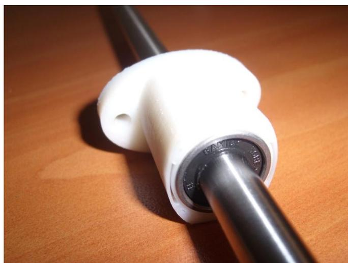
Ilustración 37: Eje con su rodamiento lineal ubicado en el soporte de rodamiento impreso por impresora 3D Touch.
