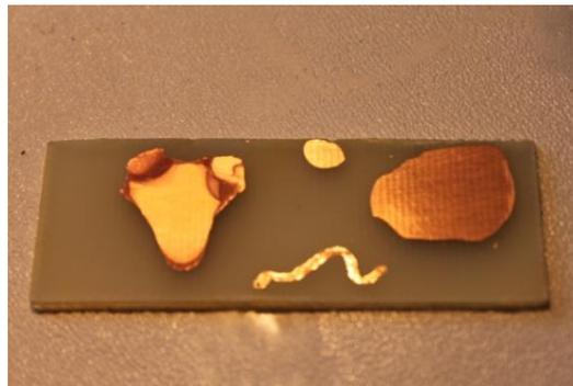
Ilustración : prueba hecha con fotopolímero y percloruro férrico, esto demuestra que si se imprime las pistas sobre la lámina de cobre se pueden crear circuitos con BeamMaker,
