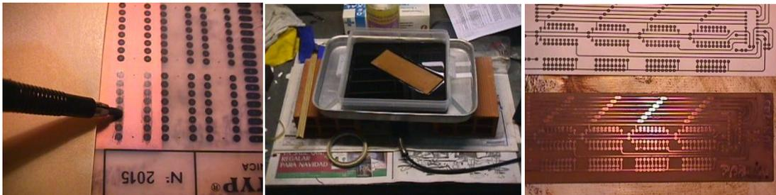
Ilustración 56: Proceso para hacer circuitos caseros, donde primero se marca con plumón las pistas deseadas, luego se baña en percloruro férrico, el ácido corroe el cobre que no tenga plumón encima, dejando intacto lo demás, así finalmente obtener la placa.
