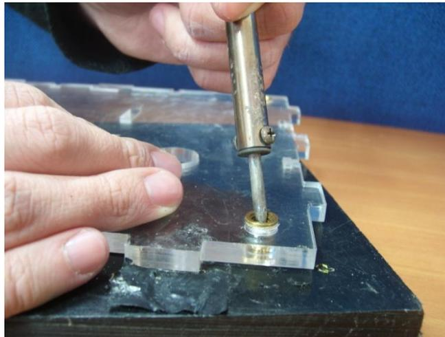
Ilustración 39: Colocando los insertos con cautín, son en total 11 insertos, 3 en los pies de la impresora y 8 en las piezas sujetoras de los ejes.
