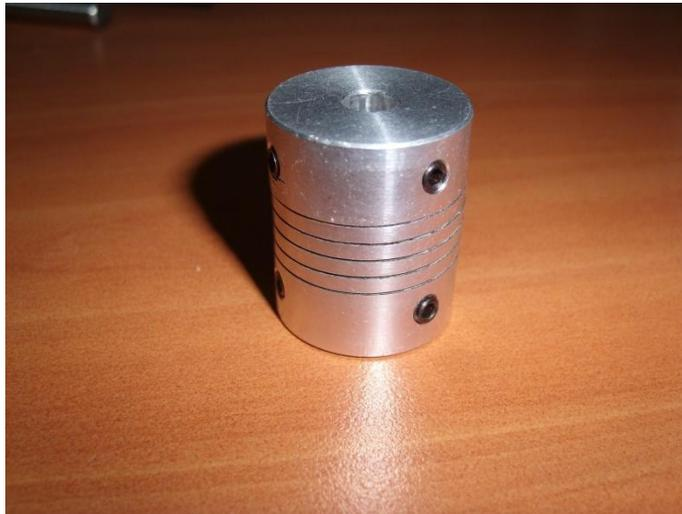
Ilustración 35: Acople MOTOR-TORNILLO
