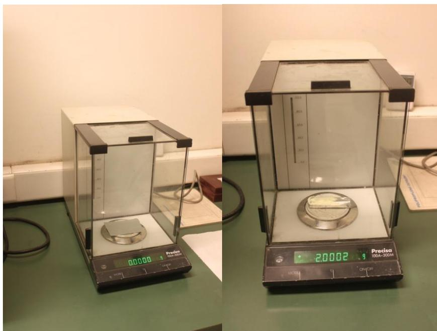
**Ilustración 15: Izquierda: Pesa digital utilizada para la obtención del fotopolímero;
