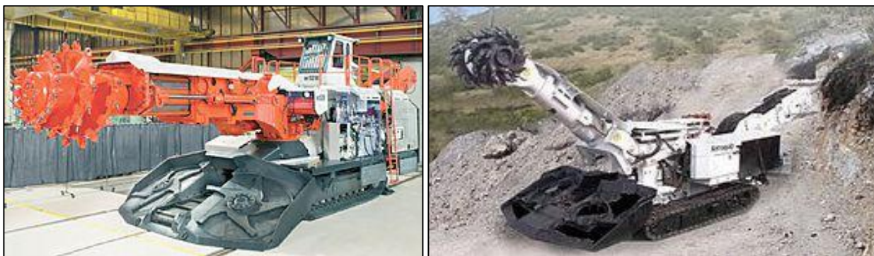
Figura B - 7. Milling (Izquierda) y Ripping (Derecha). Distintos tipos de escaradoras.
