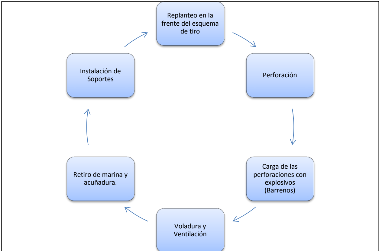
Figura A - 1. Trabajo cíclico de perforación y tronadura en roca buena.
