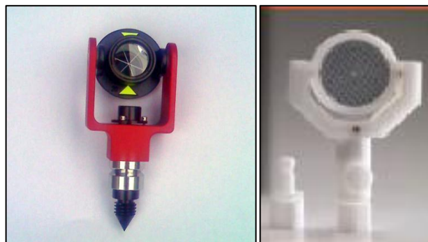
Figura B - 17. Prismas omni (izquierda) y bi-reflex (derecha) utilizados en el monitoreo interno del túnel.
