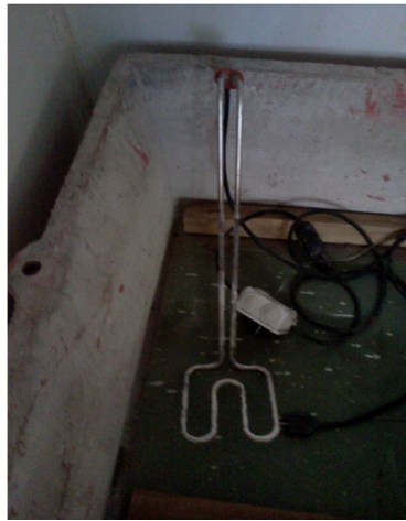
Figura 5.7. Calefactor de Inmersión Utilizado para el Control de la Temperatura.
