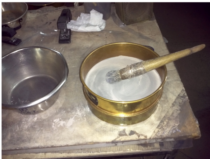
Figura 5.19. Muestras Pulverizadas Mediante Mortero Mecánico.
