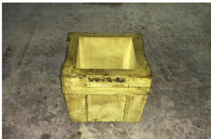
Figura 5.24. Molde para la Confección de Probetas.
