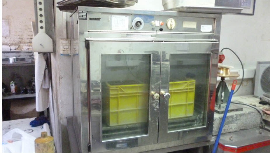
Figura 5.5. Curado Inicial de las Probetas de Mortero.
