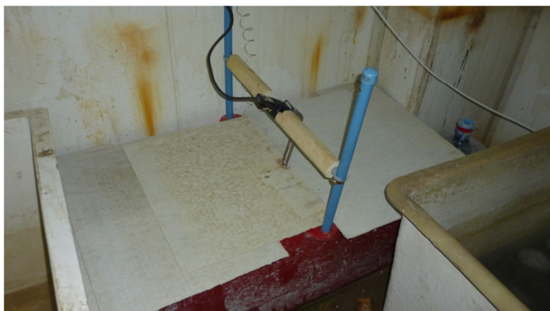
Figura 5.25. Estanque Adaptado para la Calefacción Controlada de Agua.
