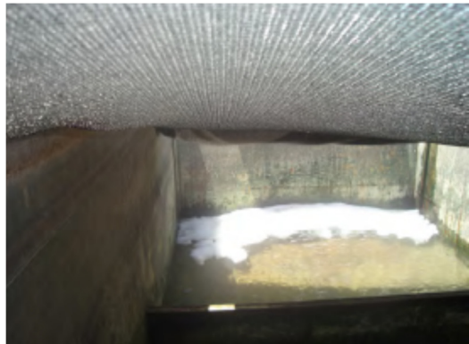
Figura 2.20. Agua de Amasado Mezclada con Hielo. (Fuente: Lagos. 2009)
