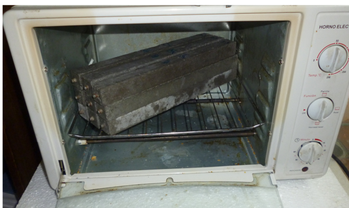
Figura 5.11. Inicio Secado de Probetas.
