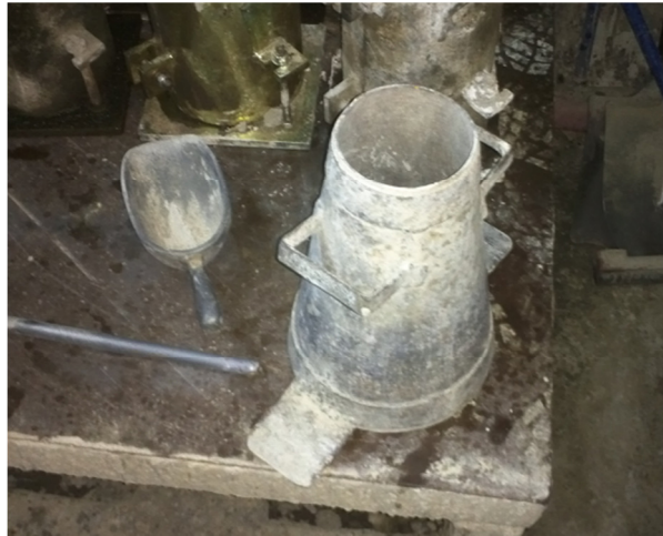
Figura 5.22. Equipo para Ensayo de Asentamiento de Cono de Abrams.
