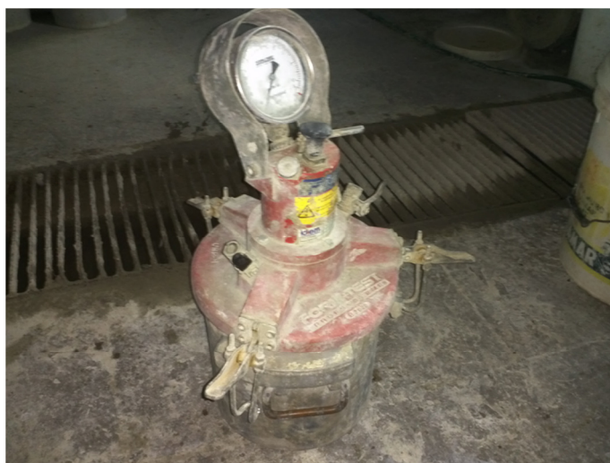
Figura 5.23. Equipo para Ensayos de Densidad Aparente y Contenido de Aire.
