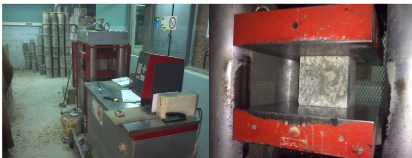
Figura 5.27. Prensa Toni Technik. Equipo Utilizado para los Ensayos de Resistencia a la Compresión.
