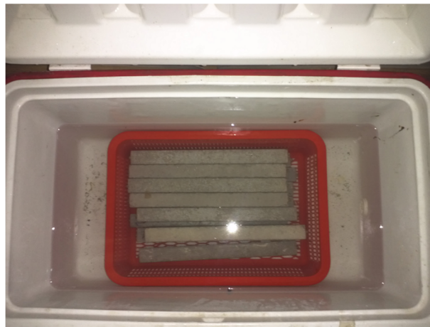
Figura 5.18. Almacenamiento de Probetas en Contenedor Térmico.
