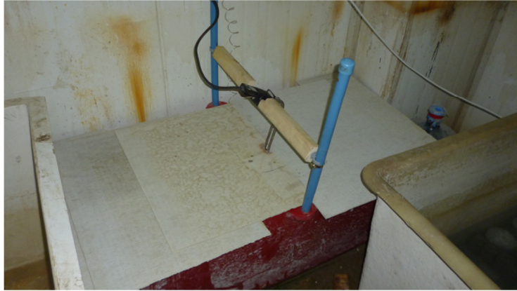
Figura 5.6. Estanque Adaptado para la Calefacción Controlada de Agua.
