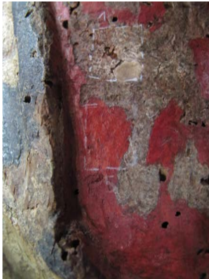
III.102. Pruebas de limpieza: tolueno (1) y agua (5)
