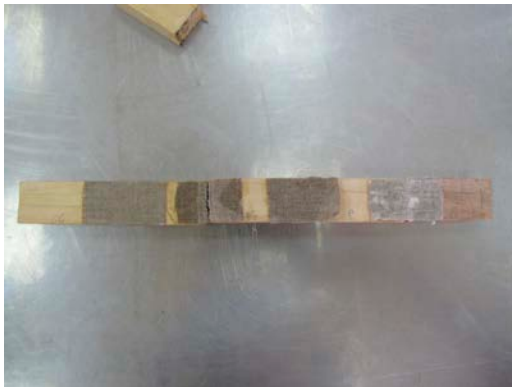
Ill. 195. Lino, en orden de izquierda a derecha: Cola de conejo, fish glue, Beva 371, Plectol.
