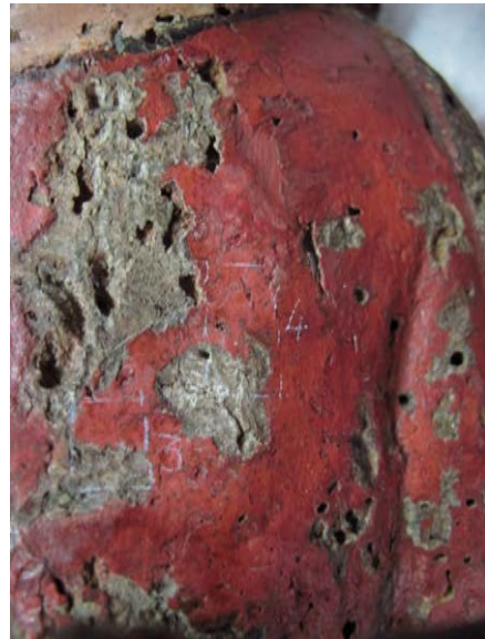
III.103. Pruebas de limpieza: Etanol (3) y acetona (4)
