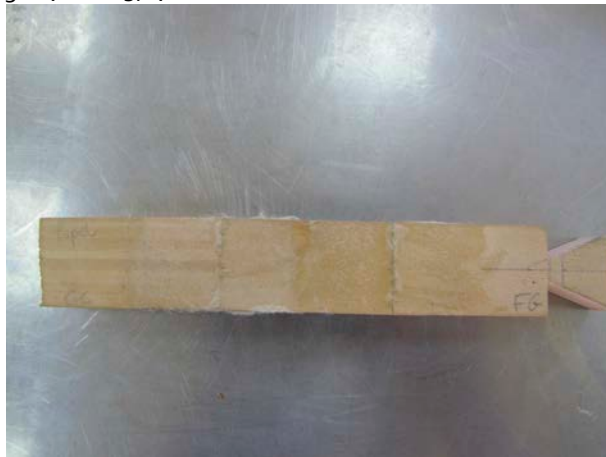
Ill. 197. Papel Japonés, a la derecha con cola de conejo y a la izquierda con fish glue.
