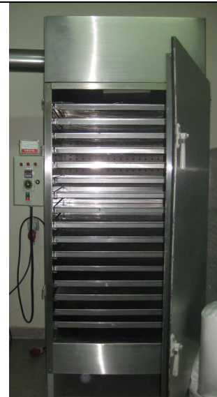
Estufa de convección (aire forzado).
