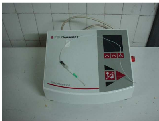
Figura 4. Analizador de gases Dansensor CheckMate 9900 utilizado para medir el porcentaje de O_2 y CO_2 al interior de las bolsas plásticas.
