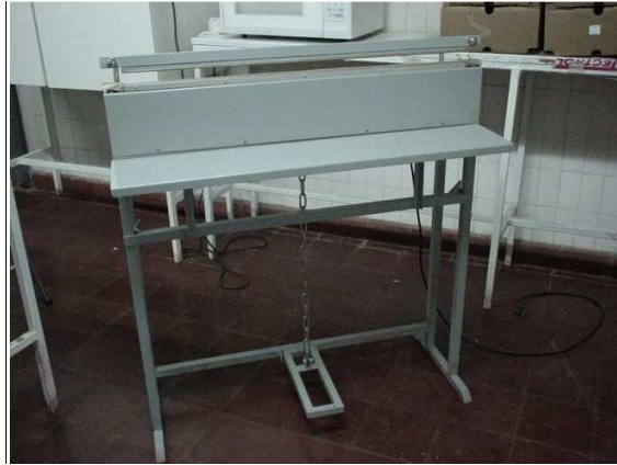
Figura 2. Selladora de bolsas utilizada para la confección de las bolsas de AM.
