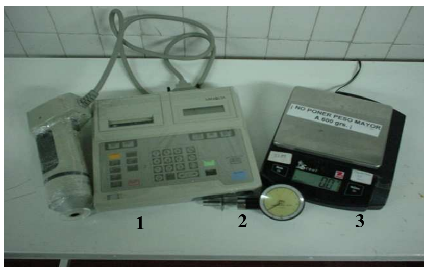
Figura 6. Colorímetro portátil tri-estimulo Minolta modelo CR-300 (1), penetrómetro manual (2) y balanza de precisión (3) utilizado en las mediciones de color, firmeza de pulpa y pérdida de peso, respectivamente.
