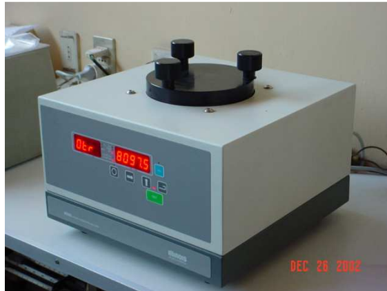
Figura 1. Medidor de permeabilidad Illinois Instruments Inc. ® , modelo 8500 utilizado en la medición de la tasa de transmisión de oxígeno (OTR) de las películas plásticas.
