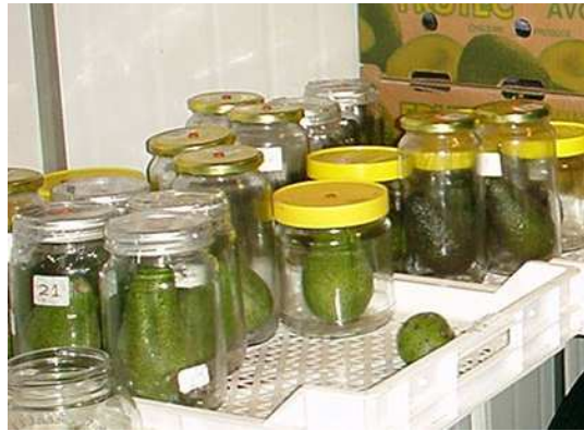
Figura 7. Sistema estático utilizado para la determinación de la tasa respiratoria en palta Hass.
