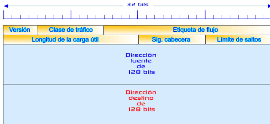
Ilustración 69. Estructura del formato de cabecera IPv6 de la RFC 2460 62 .
