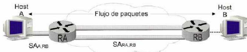
Ilustración 97. Aplicación de IPSec en modo túnel.
