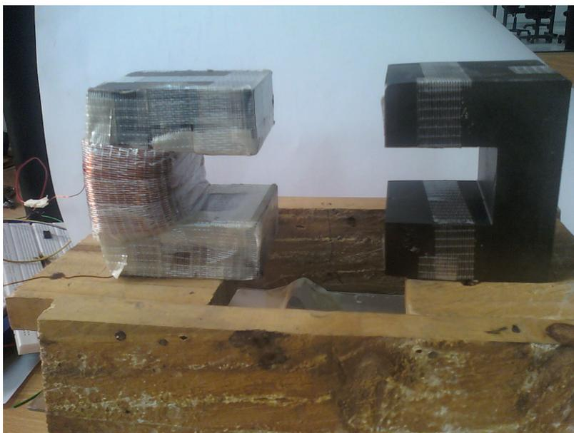
Figura 5.2: Imágen de montaje electroimán.
