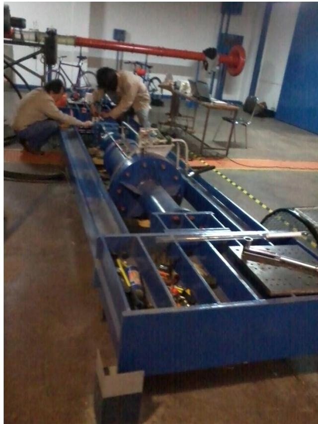
**Figura 2.7: Marco hidráulico en proceso de montaje y calibración.**
