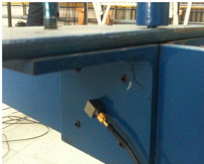
Figura 34 Acelerómetro ubicado en el nodo 6 de la estructura aeronáutica
