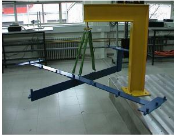
Figura 32 Condición borde libre-libre de la estructura aeronáutica
