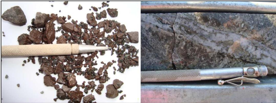
Figura IV-11 Fotografía Sondajes tipo Aire Reverso y Diamantino.
