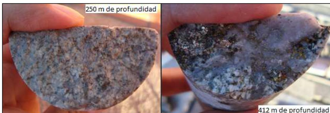
Figura III-48 Variación de ocurrencia en sulfuros a lo largo del sondaje DDH-2453.
