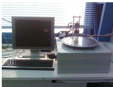
Figura 5. Medidor de firmeza Firmtech utilizado para medir firmeza en bayas de uva var. Crimson seedless tratadas con ABA y/o ethephon en enero.
