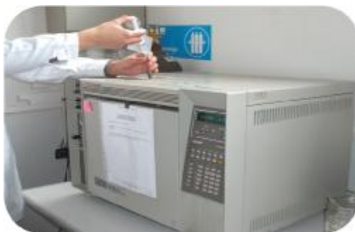
Figura 2. Medición de la tasa respiratoria mediante cromatógrafo de gases a 5 °C.
