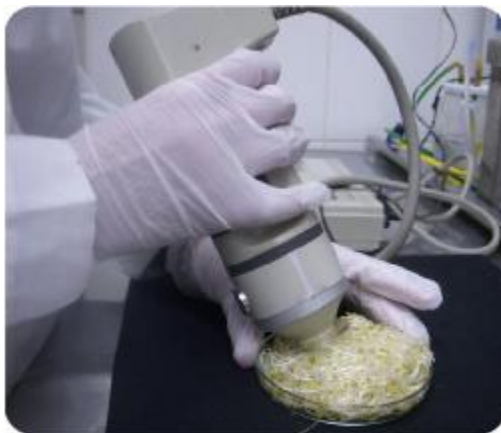
Figura 4. Medición del color de brotes de alfalfa con colorímetro compacto triestímulo.
