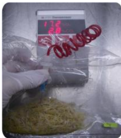
Figura 3. Medición de la concentración interna de CO 2 y O 2 de las bolsas de plástico por medio del analizador de gases manual.
