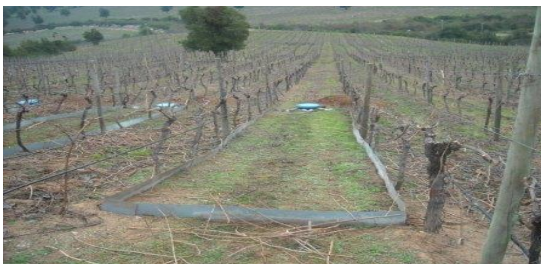
Figura 1. Unidad experimental de erosión de 20 m 2 , en viña Ventisquero.
