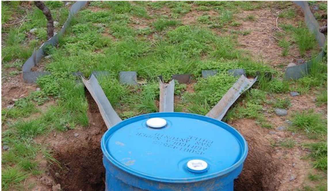
Figura 2. Zona inferior de cada parcela, estanque de recolección y dispositivo de conducción de escorrentía y sedimentos.
