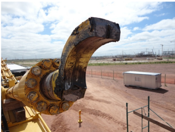
Imagen 4.5: Ojo de vástago fracturado
