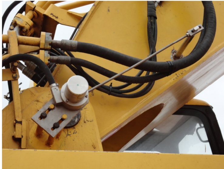
Imagen 2.8: Transductor de ángulo de la pluma
