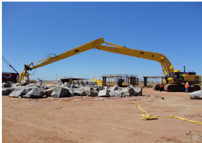
Imagen 1.3: Excavadora Komatsu PC-800 con brazo largo
