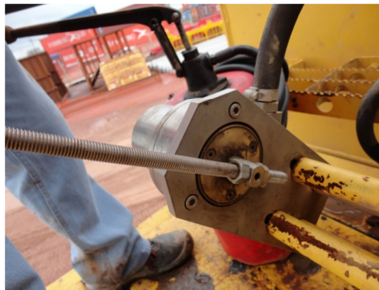
Imagen 3.5: Unión de varilla con encoder
