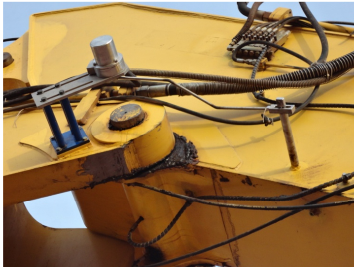
Imagen 2.9: Transductor de ángulo del stick
