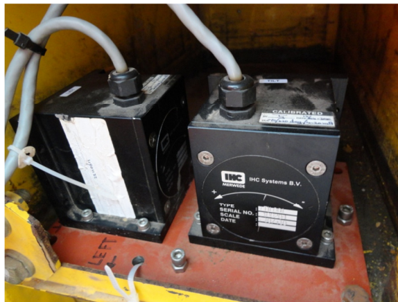
Imagen 2.12: Sensor de inclinación frontal y lateral
