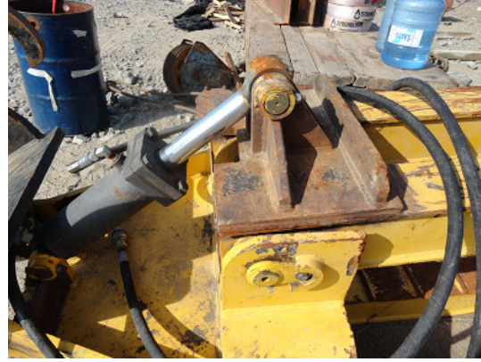
Imagen 4.4: Cilindro hidráulico del grapo
