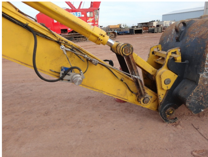
Imagen 2.10: Transductor de ángulo del balde
