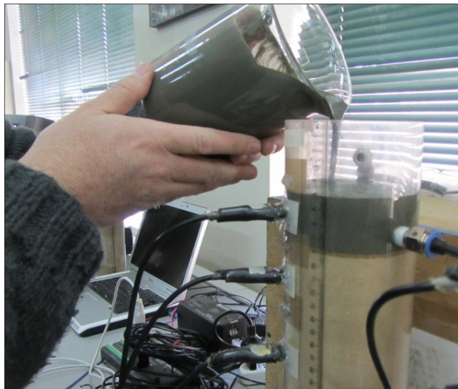
Figura 3.5: Descarga de relave espesado.
