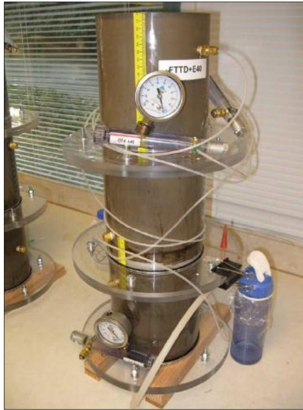
Figura 2.3: Ensayo de columna de drenaje más evaporación de 40 cm de espesor. Estrato de drenaje y sistema de colección en la parte inferior con relaves y tensiómetros en la parte superior (Junqueira et al, 2011).
