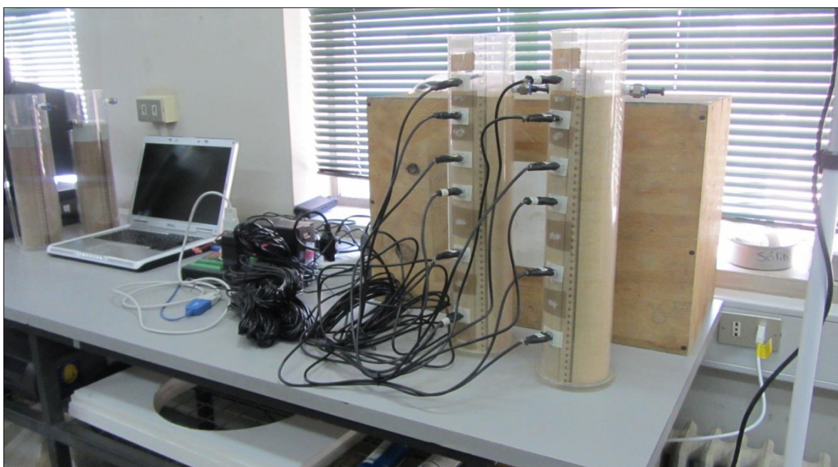
Figura 3.3: Montaje del ensayo que muestra los sensores ubicados en la columna de suelo, los cuales se encuentran conectados al sistema de adquisición de datos.
