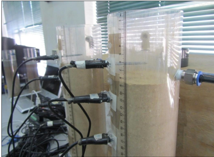
Figura 3.4: Instalación de Sensores.
