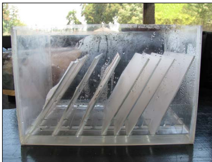
Figura 1: Caja de acrílico con las placas en su interior.
