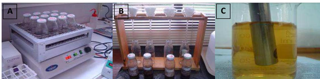
Figura 7. Conductividad eléctrica: A) Agitación de sustratos hidratados con agua destilada por 1 hora, B) Filtración de sustratos hidratados, C) Medición de conductividad eléctrica.
