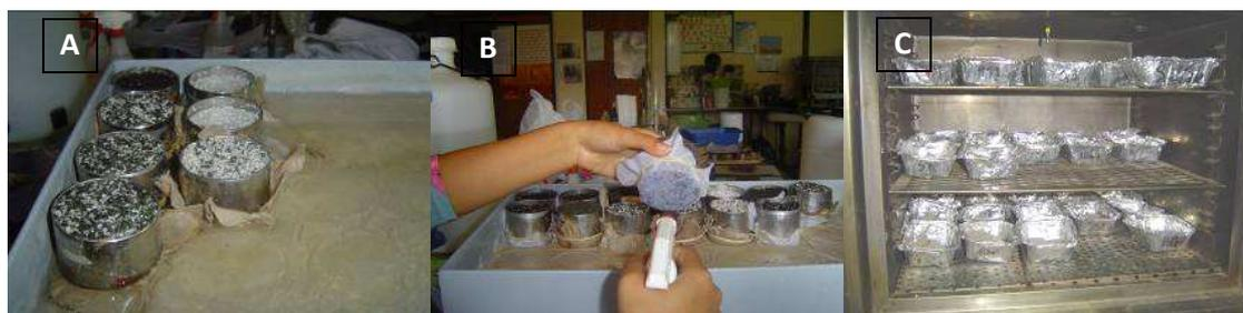
Figura 6. Curva de liberación de agua: A) Cilindros hidratados sobre cámara de arena, marca Eijkelkamp, modelo Agrisearch Equipment, Holanda, B) Humectación fondo de cilindros para no perder continuidad de agua, C) Estufa de secado de suelo, marca Soiltest Incorporated, modelo OV 18SC, Estados Unidos.
