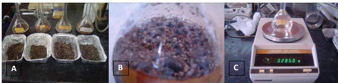
Figura 5. Determinación densidad real: A) Muestras de sustrato deshidratado, B) sustratos rehidratados y extracción de aire mediante bomba de vacío, marca Boeco, modelo R-300, Alemania, C) Pesaje de muestras en Balanza digital, marca Libror electronic Reading balance, modelo ED-2000.
