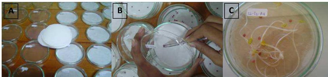
Figura 8. Test de toxicidad por germinación: A) Placas de Petri con papel filtro humectado, B) Siembra de placas para cámara de germinación, C) Germinación de semilla de rabanitos *Raphanus sativus L* var. Sparkler).
