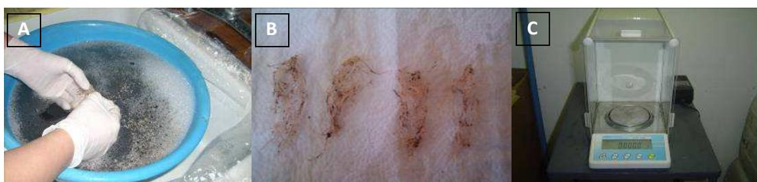
Figura 10. Preparación raíces para evaluaciones: A) Lavado de raíces, B) Estilado de raíces antes de secado, C) Medición materia seca con balanza digital de precisión, marca Adam, modelo AAA 100L.
