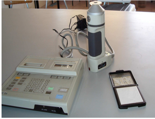
Figura 3. Colorímetro portátil tri-estímulo Minolta modelo CR-300 utilizado para la medición de los parámetros colorimétricos de cascos de pera cv. Packham's Triumph.
