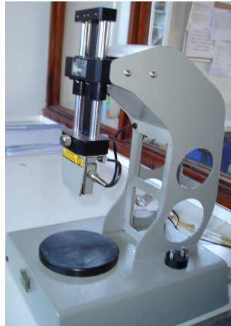
Figura 4. Penetrómetro motorizado utilizado para la medición de la firmeza de cascos de pera cv. Packham's Triumph.
