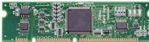
**Figura 29: Tarjeta de control que utiliza un DSC**
