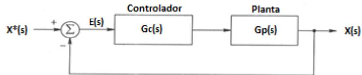
**Figura 25: Esquema de lazo cerrado de control**
