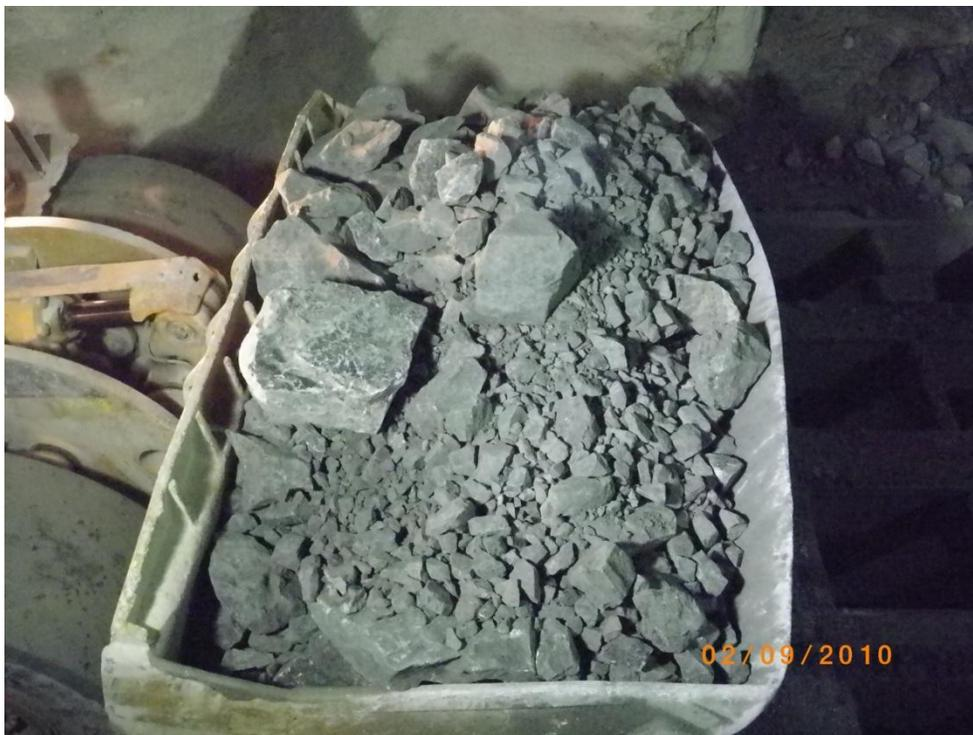
Figura 3.13 : Ejemplo de imagen para análisis de fragmentación.
