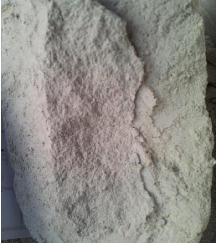
**Figura N° 50: Corte longitudinal, probeta tipo Apisonamiento húmedo.**
