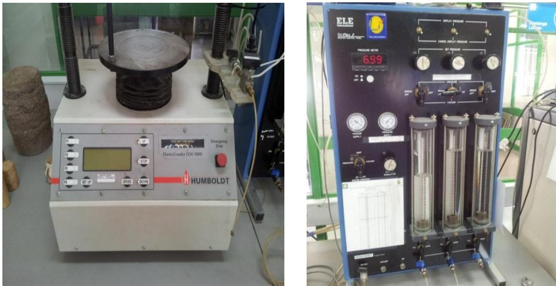
Figura N° 23: Equipo Triaxial utilizado.
