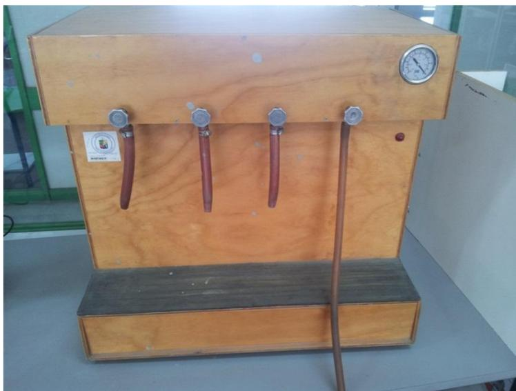
**Figura N° 28: Compresor de aire, utilizado para generar vacío en las probetas.**
