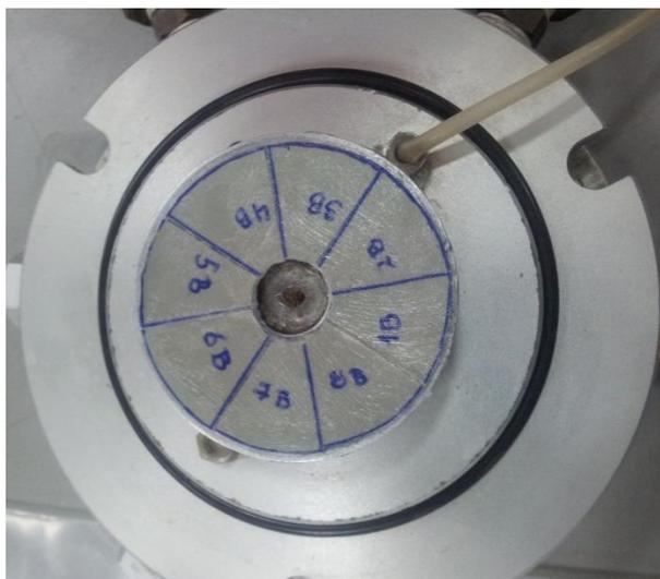
**Figura N° 25: Extremos lubricados en el cap inferior.**
