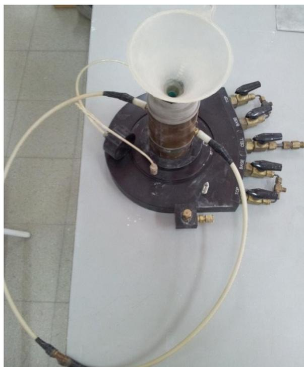
**Figura N° 29: Sistema de mangueras para generar vacío y disposición del embudo, previo a la depositación del relave.**
