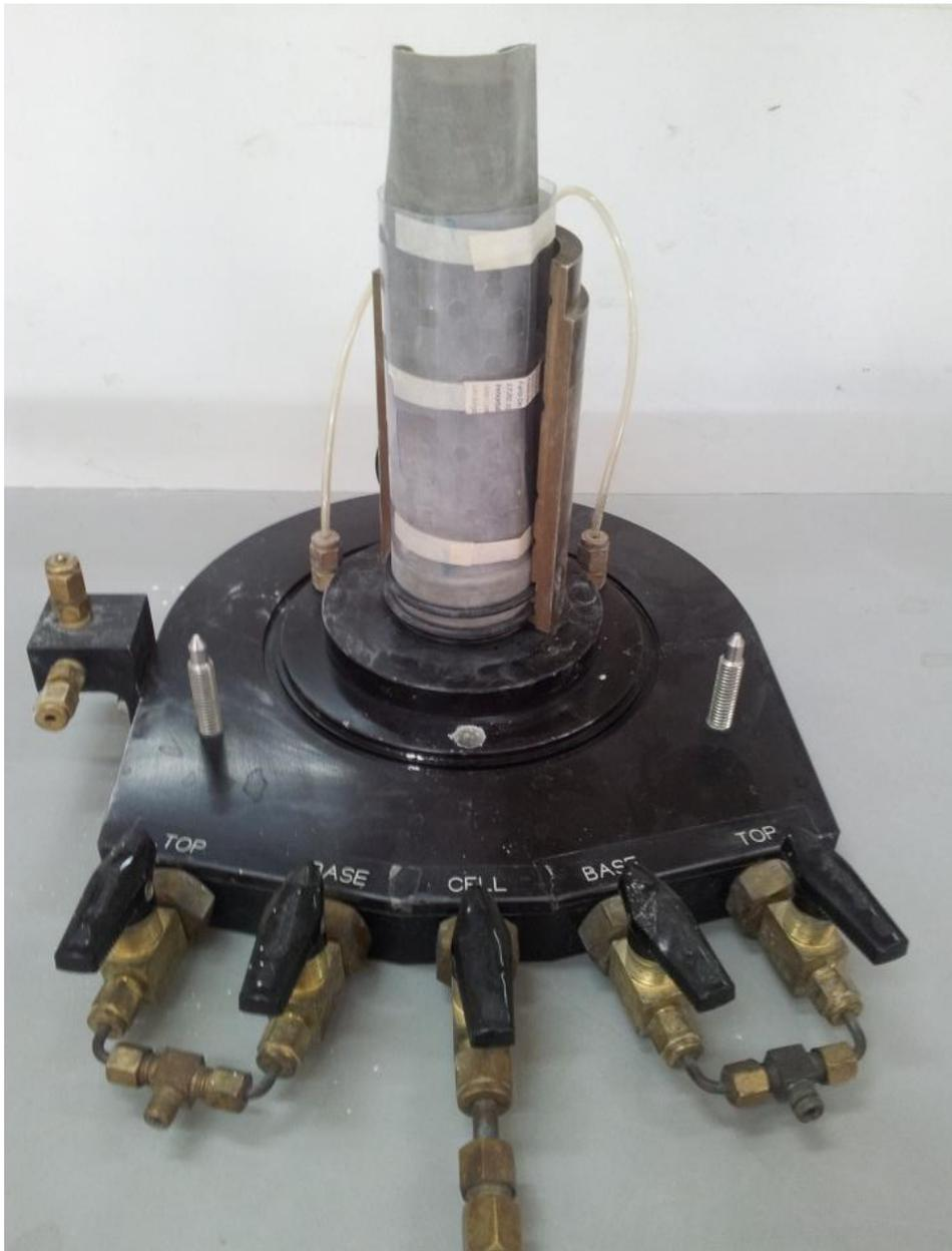
**Figura N° 27: Colocacion de la mica entre la membrana de latex y el molde de bronce.**
