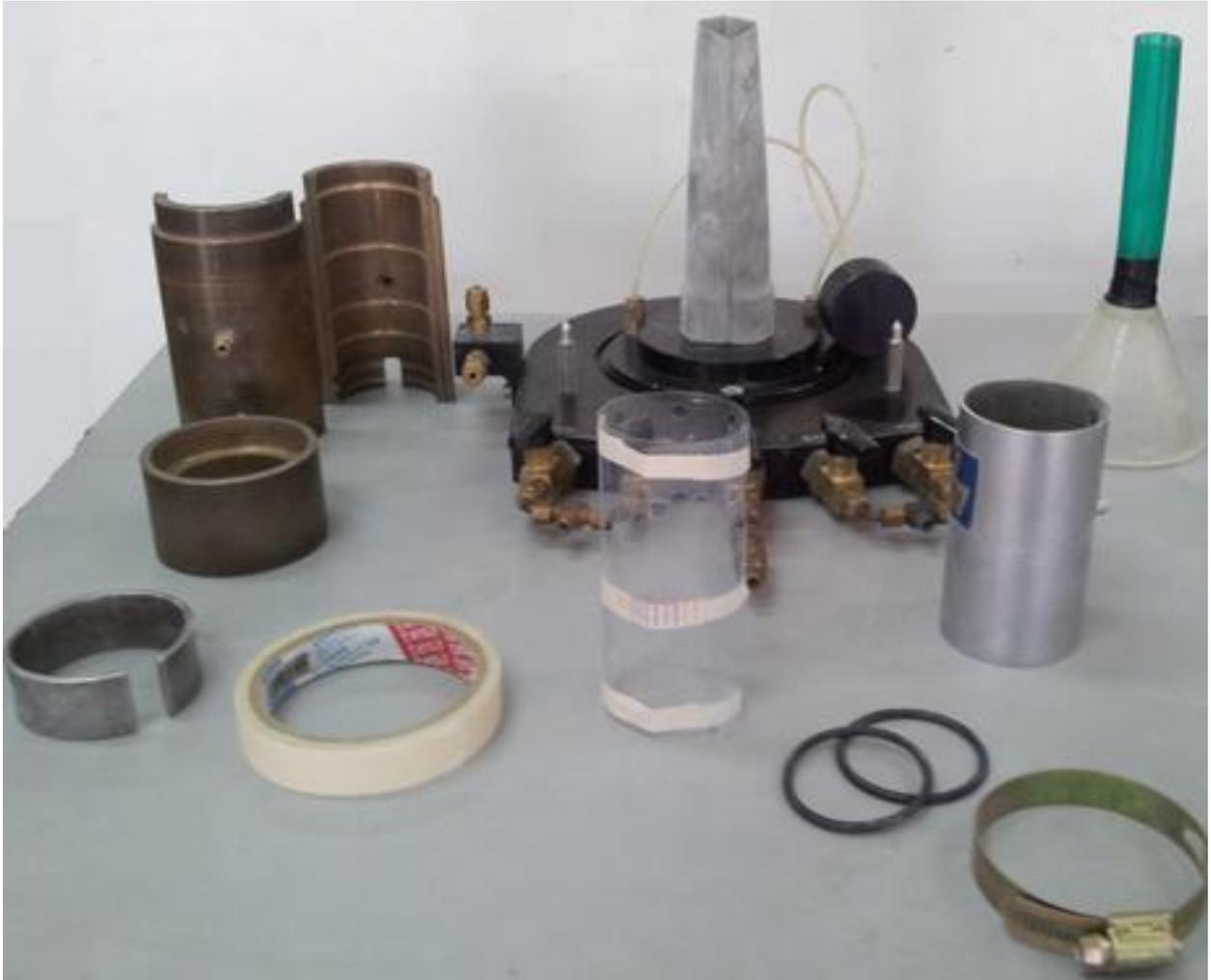
**Figura N° 26: Implementos adicionales para montaje probeta tipo slurry.**
