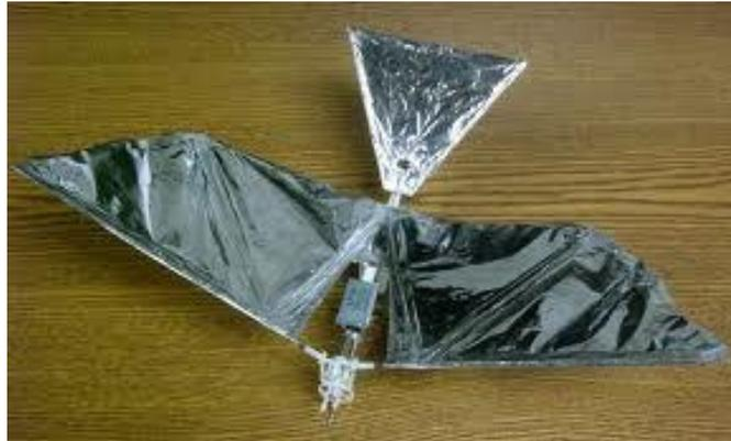
Figura 4.- Small Bird, con cola tipo timón para controlar la dirección
