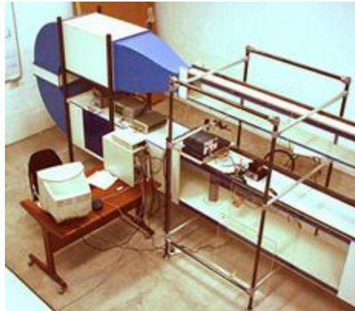
Figura 38.- Túnel de viento utilizado para las mediciones.
