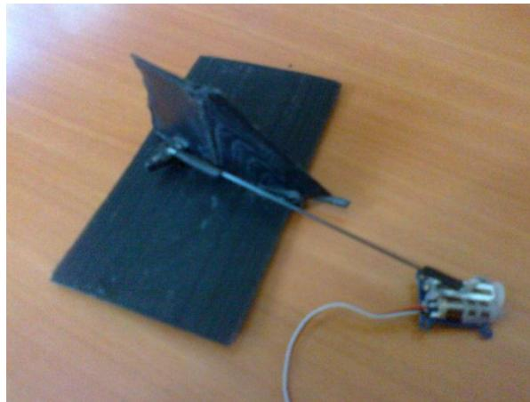
Figura 25.- Cola tipo Timón junto al actuador lineal utilizado
