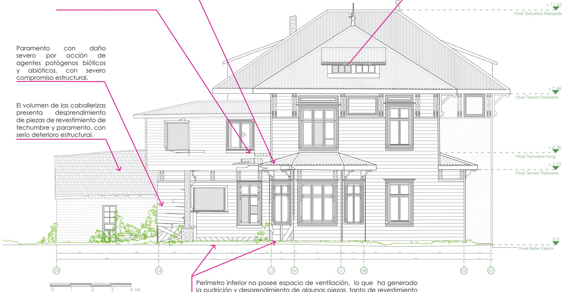
Perímetro inferior no posee espacio de ventilación, lo que ha generado la pudrición y desprendimiento de algunas piezas, tanto de revestimiento como en la estructura
