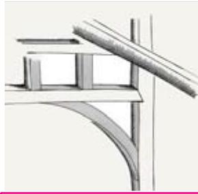
Detalle estructura del arco, de tipo deprimido, construido en maño.
