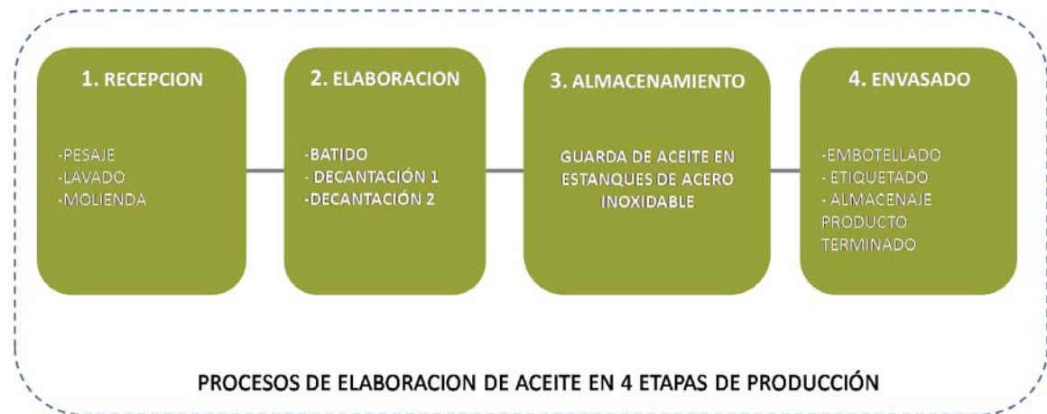
FIG. 16. ESQUEMA CONCLUSIVO SOBRE LAS ETAPAS QUE ENLOBA EL PROCESO DE ELABORACIÓN DE ACEITE DE OLIVA. ELABORACIÓN PROPIA
