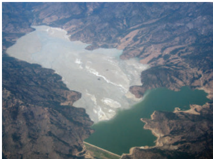
Imágenes: Canal de Relave de la mina El Teniente en su trayecto hasta el tranque Caren.
